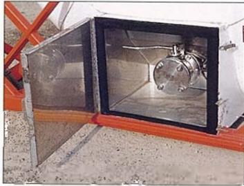
⑦ 下部排出口 底弁開閉レバー(断熱材付)
