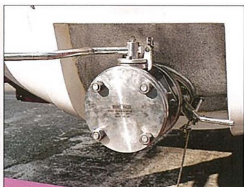
⑦ 下部排出口 底弁開閉レバー
