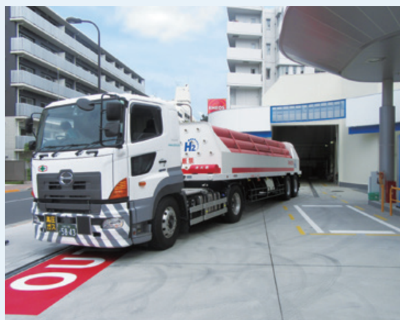
固定式水素ステーションに配送する圧縮水素トローラー
