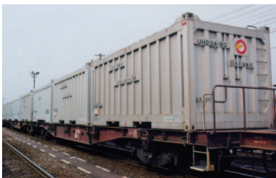
発送を待つ20ft 合成樹脂専用アルミホッパコンテナ(京葉久保田駅)
