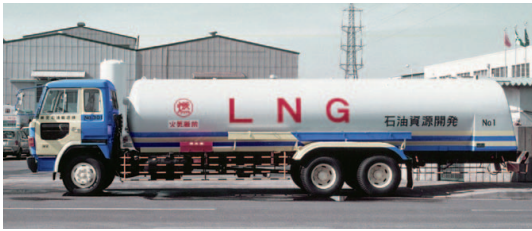
6t積 LNG タンクローリーの1号車 輸送にあたり、最初に4両が建造された。
