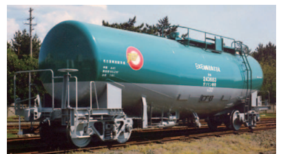
44t積ガソリン専用タンク車(タキ43000形式243000番台)
