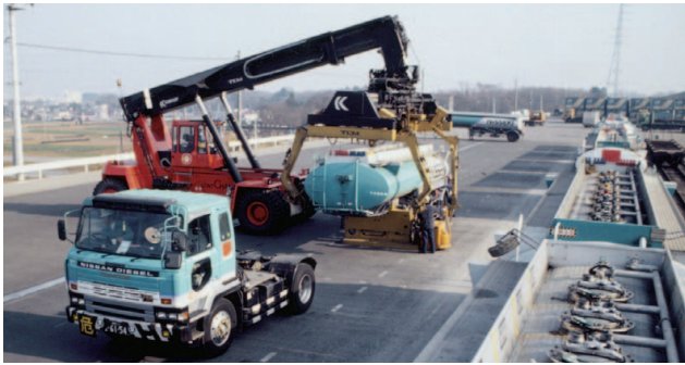
リースタッカーによる石油ピギーバック輸送の荷役作業(新座貨物ターミナル)
