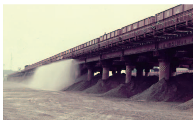
列車編成のままでの自動装置による一斉取り下ろし(35t積石灰石専用ホッパ車、ホキ9500形式)
