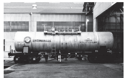
35t積エチレングリコール専用タンク車
