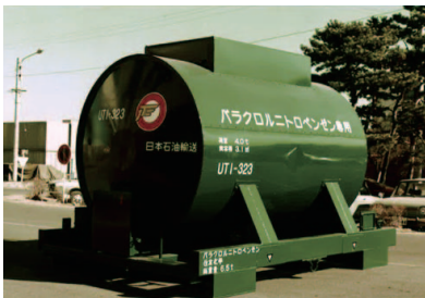
4t 積パラクロルニトロベンゼン専用タンクコンテナ
