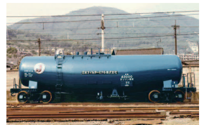
日本オイルターミナル向けに開発した43t積タンク車
