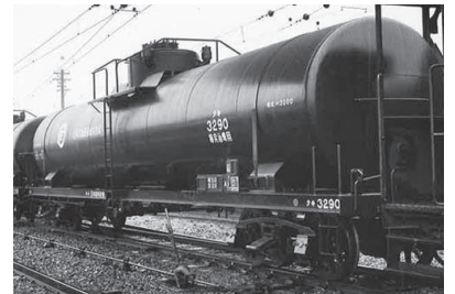
揮発油専用の30t 積タンク車 (1954年7月建造)
