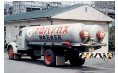
アメリカ製のタンクを搭載したわが国初のLPG用タンクローリー
