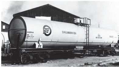
15t積LPG専用タンク車
