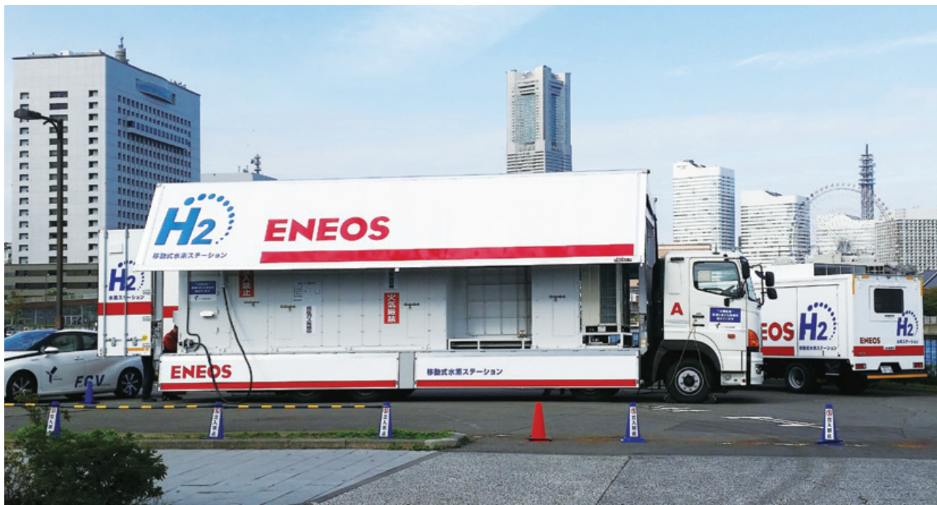
移動式水素ステーション
