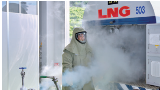
LNG漏洩再現と耐冷服実証実験 LNGの漏洩を再現し、耐冷服の有効性や漏洩事故への対応を確認します。
