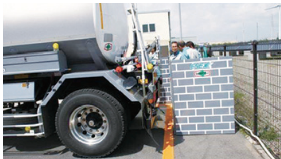
後退訓練 後退で壁の20cm手前まで近づけ、停車させます。
