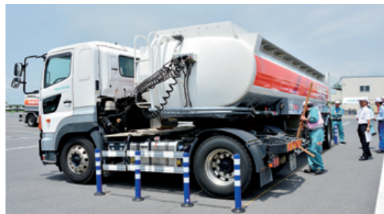
縦列駐車 幅10mの枠にトラクターとトレーラーの角度が90度になるよう停車させます。
