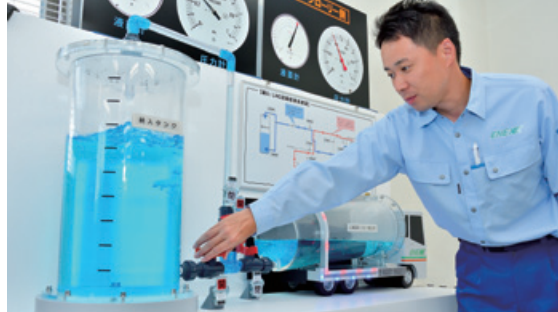
LNG流動模型 LNGや圧力の流れを可視化することで、積込、納入作業の仕組みが理解できます。
