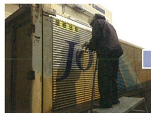
ウィングコンテナの外装洗浄
