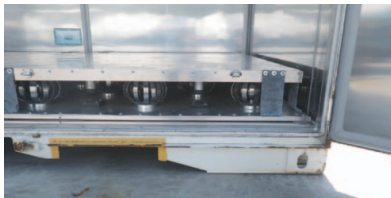
試作した防振床 大阪-東京間でテスト輸送を行った
