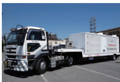
圧縮水素トレーラー
