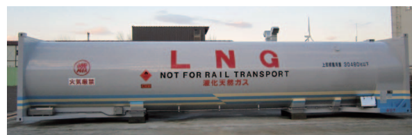
40ft LNG タンクコンテナ
