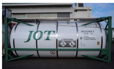
臭気抑制仕様 ISO タンクコンテナ
