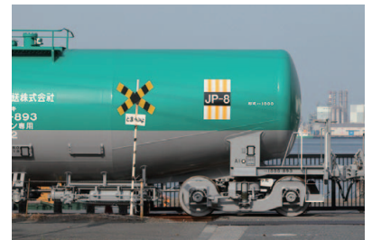
米軍向けタンク車には積載品を示す「JP-8」の表記がある
