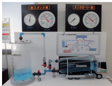
LNG流動模型(積込・荷卸時のLNGの挙動を水を用いて再現)
