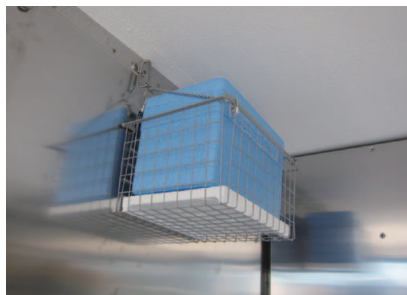
ドライアイス吊り下げ金具、天井は結露防止のため防湿塗料を塗布
