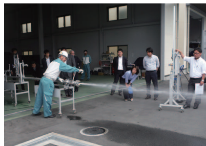
液体窒素を使用した漏洩再現
