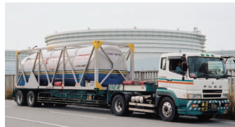
トレーラーに積載された LNG コンテナ
