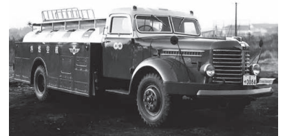
羽田空港向け航空燃料輸送用タンクローリー
