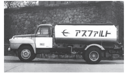
アスファルト用タンクローリー
