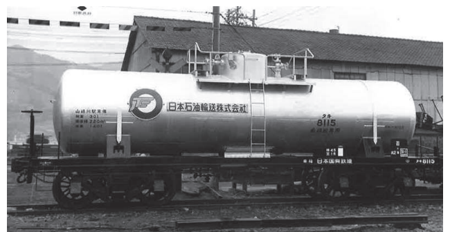
30t積希硝酸専用タンク車(タキ 8100形式)
