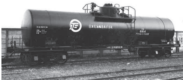
30t積アクリルニトリル専用タンク車(タキ 6900形式)
